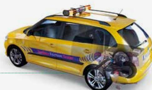
Kada govorimo o ispitivanju kvalitete betonskih kolnika in-situ, možemo također govoriti u sličnim terminima kao i kad govorimo o stanju kod nas puno više zastupljenih - asfaltnih kolnika. PAVEMENT ALLIANCE nudi upravo opremu za ispitivanje svih traženih karakteristika (fricija, ravnost, makrotekstura, geometrija, kolotrazi, stišljivost, pukotine, retrorefleksija, podaci o kolničkom inventaru itd.).
